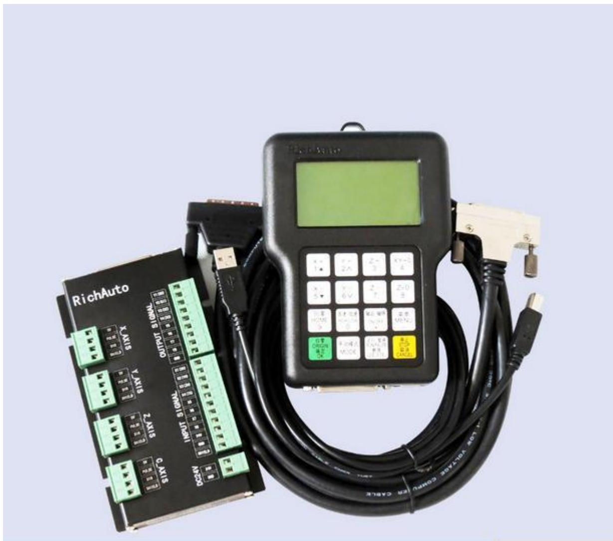
DSP контроллер A11 построен на базе 8-ми ядерного процессора SPARTAN-6 обеспечивает быструю работу автоматический контроль фрезерования по трем осям с высокой скоростью. Контроллер полностью автономный и не требует подключения ПК. Система управления использует стандартные G-коды и HPGL-3D коды, что позволяет формировать задания, используя самые распространенные программные пакеты: ArtCam, Type3, Pro-E, MasterCAM, UG, САХА и т.п.
